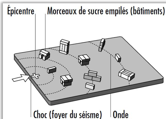
Puis, pousser d'un côté par petits coups secs de plus en plus forts en observant les dégâts successifs sur les constructions selon leur position par rapport au point de départ de la vibration et selon le sens des ondes.
